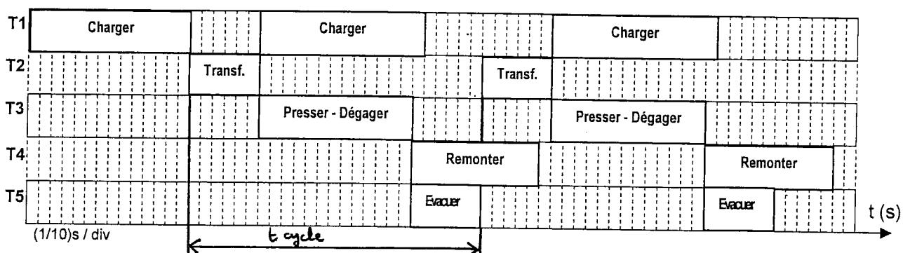
II. 10 Déterminer la durée du nouveau cycle de presse en fonctionnement stabilisé. Conclusion.
