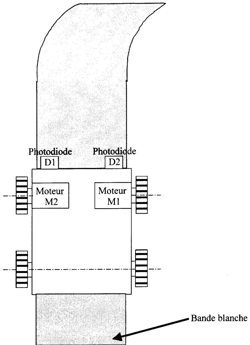
Ce véhicule de transport autonome permet d'apporter de la marchandise en suivant une bande blanche, quelle que soit la courbure de celle-ci, grâce à deux photodiodes D1 et D2 sensibles à l'éclairage de cette bande blanche ; les moteurs M1 et M2 réagissent en conséquence pour suivre ce trajet. Le schéma du montage complet est donné en page 5/6.
