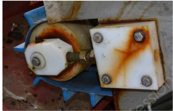
**Solution envisagée :** Un ressort de compression sera implanté permettant une tension continue des tapis à tasseaux.
