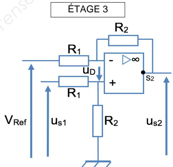
Q32. Expliquer la raison pour laquelle  $R_2$  sera réglée à la valeur 92 k $\Omega$ , sachant que :  $R_1 = 10$  k $\Omega$ ,  $V_{ref} = 0,272$  V, et  $u_{s1} = 0,272 + 43,5 \cdot 10^{-3} \times v_{vib}$ .
