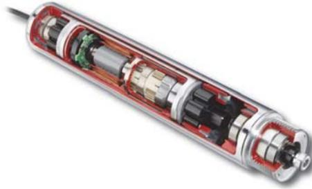
NILPAHC89E sont des moteurs synchrones qui sont alimentés par une source électrique à courant continu via un inverseur électronique intégré / commutation d'alimentation, qui produit un signal électrique alternatif entraînant le moteur. Dans ce contexte, l'appellation courant alternatif ne signifie pas une forme d'onde sinusoïdale, mais plutôt un courant DC bi-directionnel. L'électronique de contrôle permet d'assurer la commutation des phases du moteur et d'agir sur la fréquence de rotation.
