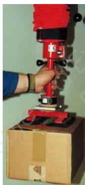
**Les ventouses à un soufflet** sont utilisées sur des produits plans ou légèrement galbés. Pour une bonne prise, l'axe de la ventouse doit être perpendiculaire à la surface de préhension.
