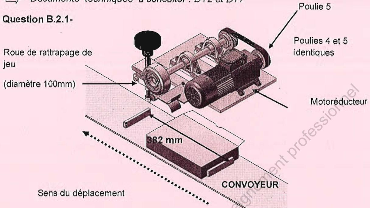
Sachant que les cadences souhaitées peuvent varier de 30 boîtes par minute minimum à 150 boîtes/min maximum, calculer  $V_{\min\_convoyeur}$  et  $V_{\max\_convoyeur}$ .
